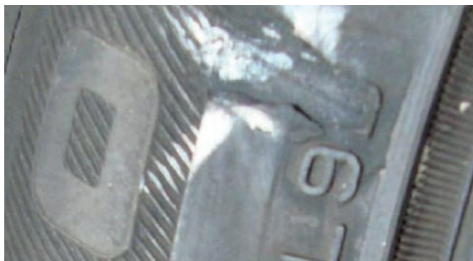
Kleine Schrammen, Stahlchord und Abdecklage nicht sichtbar.
